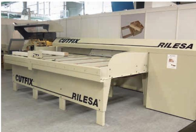
▲ Die Präzisionskappsäge Cutfix ermöglicht bis zu zehn Schnitte pro Minute
